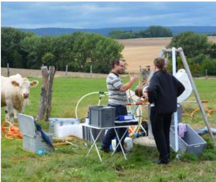
Abb. 11: Grundwasserprobenahme am Rüspelsweg aus Lysimetern. (Foto: R. Lehmann)
