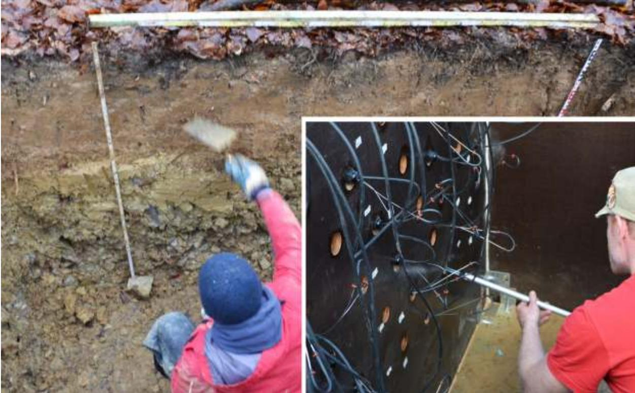
Abb. 36: Profilgrube am Reckenbühl/Großer Schneisenweg, in der eine Bodenhydraulik-Messgrube (Detail, rechts: Installation von Bodenfeuchte- und Bodenwasserspannungssensoren) errichtet wurde. (Fotos: R. Lehmann)
