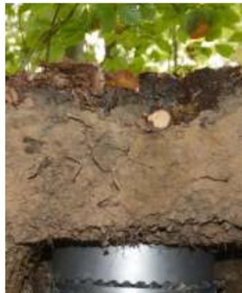
Abb. 34: Kleinlysimeter (Sickerwasser-sammler) dienen der ungestörten Entnahme von Bodensickerwasser.(Foto: D. Reichel)
