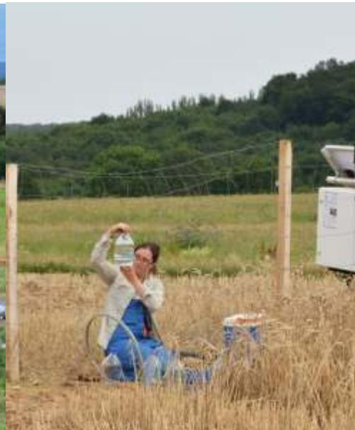
Abb. 12: Probenahme von Bodensickerwasser. (Foto: R. Lehmann)
